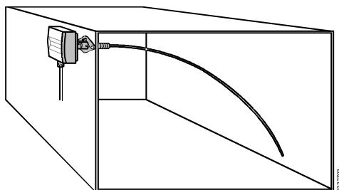
3. Montageflansch montieren
