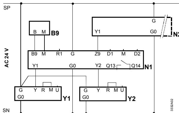
Ablufttemperaturregelung mit Minimalbegrenzung der Zulufttemperatur
